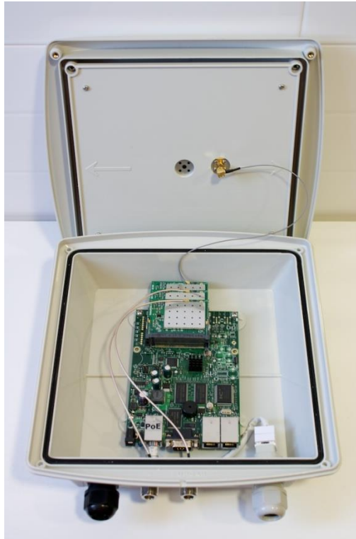
Ilustración 42 - Caja estanca, router y radio 39 -
