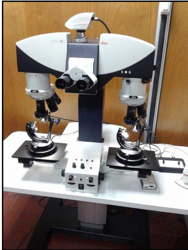
Imagen N°22: estudio de tejido textil en microscopio comparador balístico Leica FSC. Fuente: Elaboración propia.
