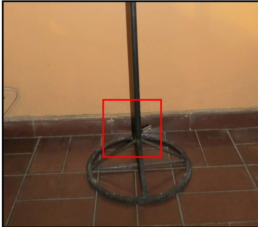
Imagen N°14: gancho para regular altura de bastidor. Fuente: Elaboración propia
