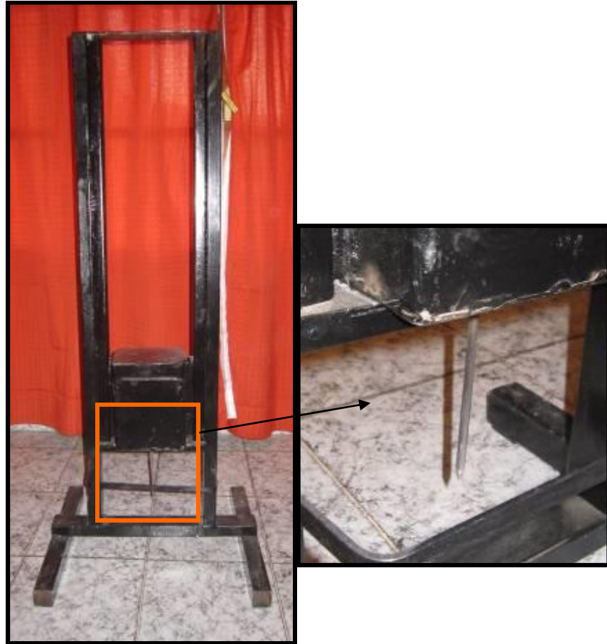
Imagen N°17: Soporte contenedor del arma punzante o perforante. Fuente: tesina de grado realizada por Lic. J. Menéndez. (2014)
