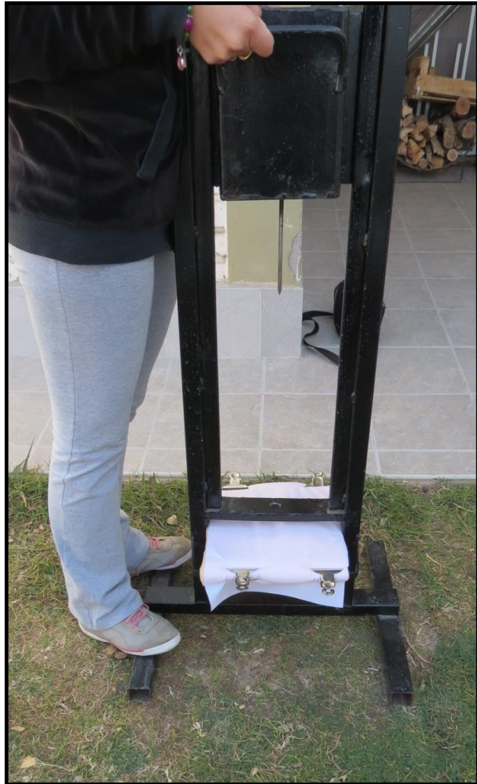
Imagen N°25: material colocado en bastidor y masa suspendida. Fuente: Elaboración propia.
