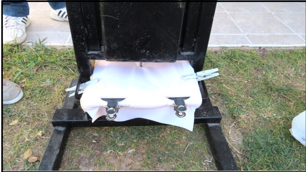
Imagen N°26: material perforado por arma blanca. Fuente: Elaboración propia.
